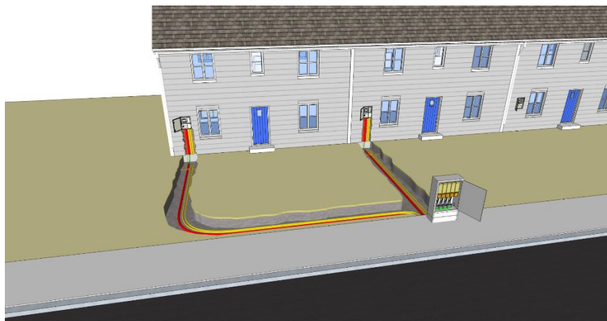
Figur 15 Eksempel på stikkledning mot rekkehus
